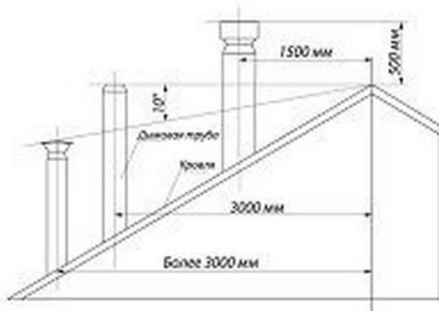
Рис.1. Определение высоты наружной части дымохода
